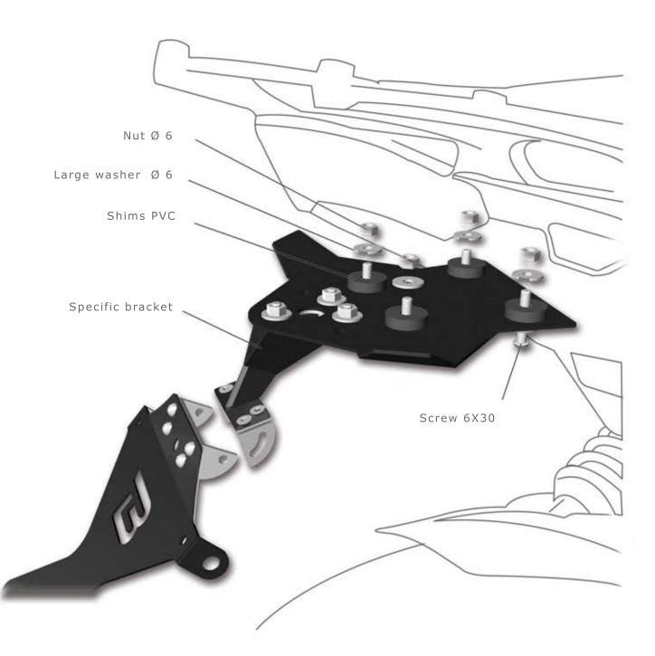
REMOVE THE ORIGINAL LICENCE PLATE AND DISASSEMBLE THE ORIGINAL TAIL LIGHT. FIX IT TO THE SPE-CIFIC BRACKET USING THE ORIGINAL SCREWS. ASSEMBLE BARRACUDA LICENCE PLATE USING THE 6X30 SCREWS.
