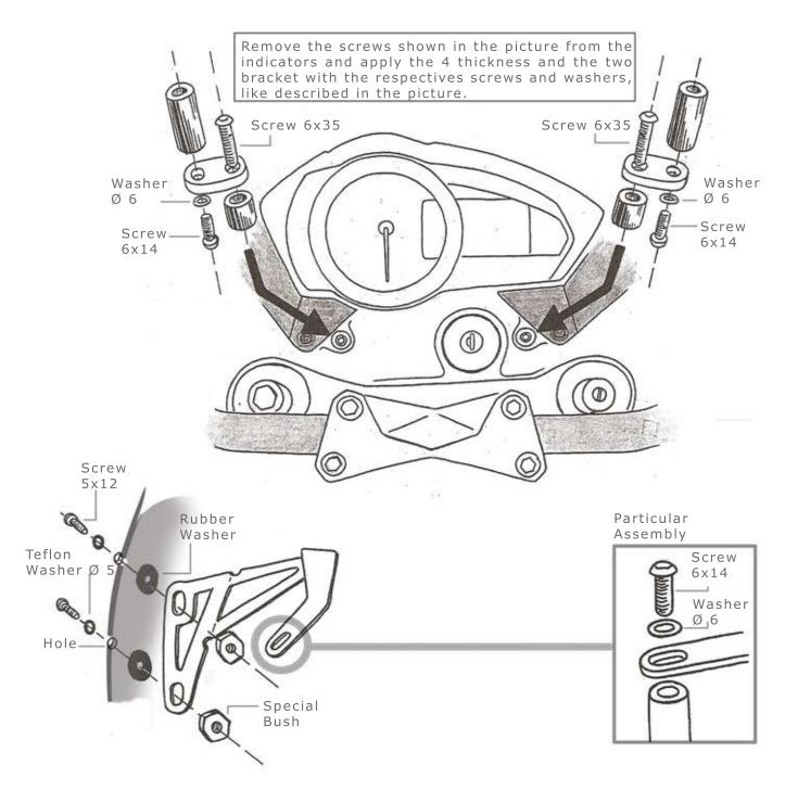
FIX THE BRACKET ON THE WINDSHIELD/SCREEN USING TEFLON WASHERS ON THE OUTSIDE AND THE RUBBER LARGE WASHERS ON THE INSIDE. POSITION THE WINDSHIELD/SCREEN ON THE MOTORBIKE FIXING THAT WITH THE 6X14 SCREW AND THE WASHER.
